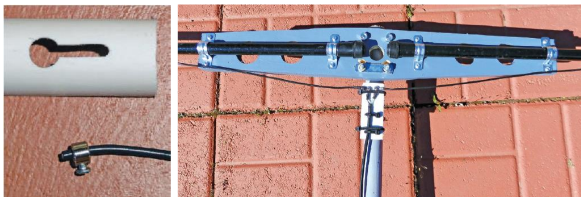
Fot. 1.1.4.4. Izolatory łączące końce promiennika i reflektora
