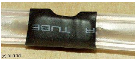
Fot. 4.2.7. Możliwy sposób zabezpieczenia przerwy za pomocą koszulki termokurczliwej
