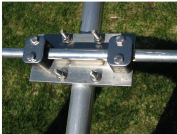
Fot. 4.7.7. Montaż elementów biernych w antenie na 50 MHz
