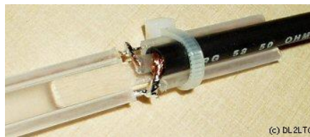
Fot. 4.2.7. Możliwy sposób zabezpieczenia przerwy za pomocą koszulki termokurczliwej
