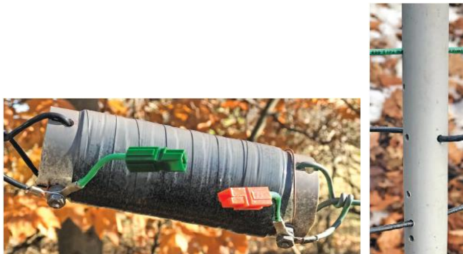
Fot. 1.1.5.5. Cewka przedłużająca dla pasma 80 m bez podłączonej zwory. Cewka jest owinięta taśmą izolacyjną dla stabilizacji uzwojenia i zabezpieczenia go przed wpływami otoczenia. Cewka została pomalowana na szaro ze względów estetycznych. Po prawej stronie znajduje się przewód dla pasma 80 m, a po lewej – główna część dipola dla pasma 40 m
