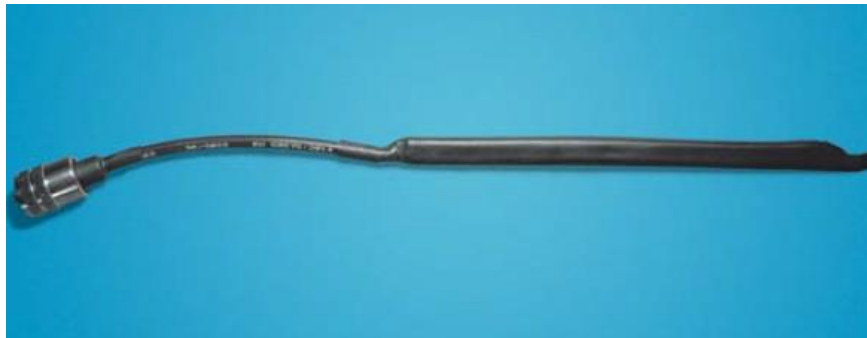
Fot. 1.2.12.3. Połączenie strojnika z resztą kabla
