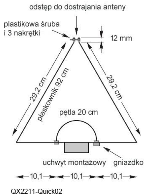
Fot. 4.3.1. Trójkątna antena pętlowa na 2 m z pętlą zasilającą
