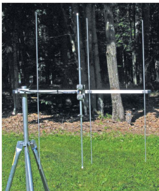
Fot. 4.7.1. Antena dwumetrowa zamontowana w pozycji pionowej na trójnogu
