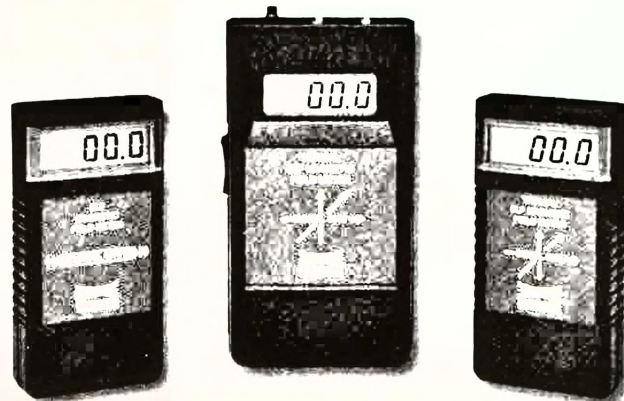
Rys. 9. Przenośne mierniki pola magnetycznego małej częstotliwości firmy F. W. Bell
