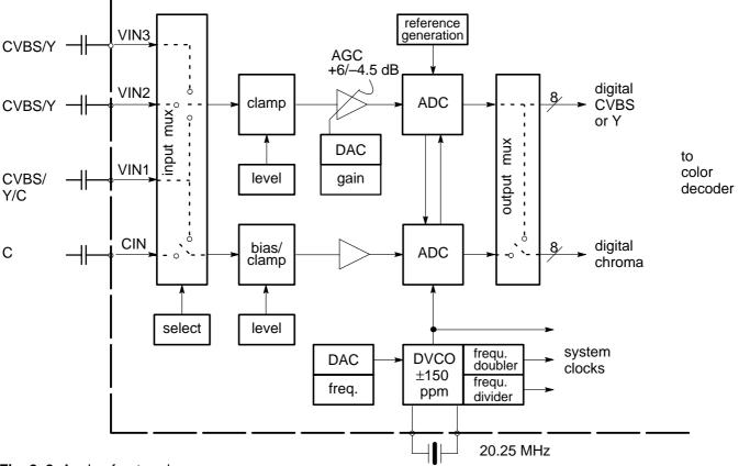
Fig. 2–2: Analog front-end
