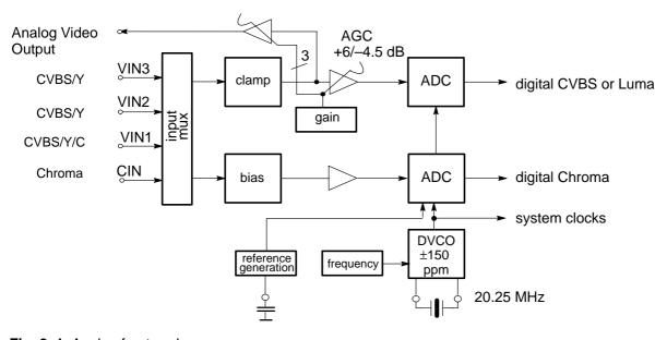
Fig. 2-1: Analog front-end
