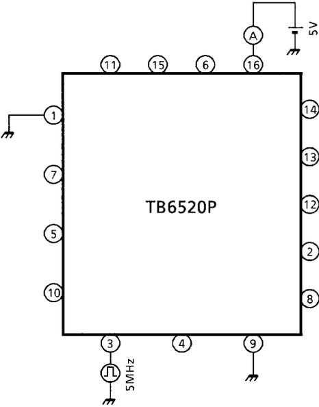
**TEST CIRCUIT 2: I<sub>DD</sub> (opr.)**
