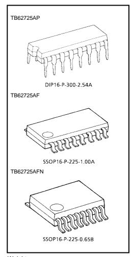
Weight DIP16-P-300-2.54A: 1.11 g (typ.) SSOP16-P-225-1.00A: 0.14 g (typ.) SSOP16-P-225-0.65B: 0.07 g (typ.)
