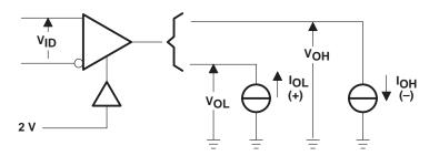
Figure 1. V<sub>OH</sub>, V<sub>OL</sub>
