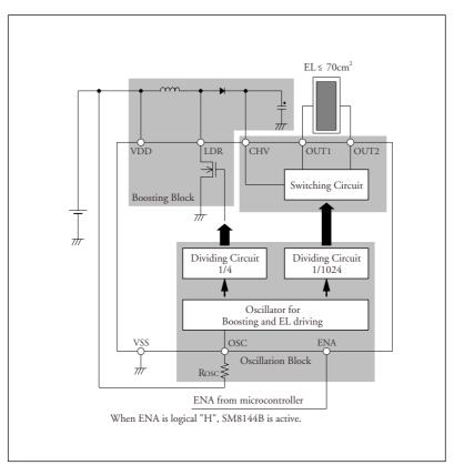
Figure 1. SM8144 Block Diagram
