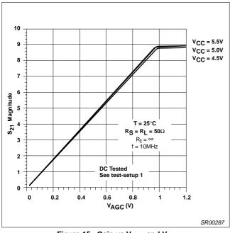
Figure 15. Gain vs  $\rm V_{AGC}$  and  $\rm V_{CC}$
