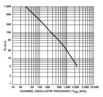
FIGURE 11. RESISTANCE RT vs FREQUENCY
