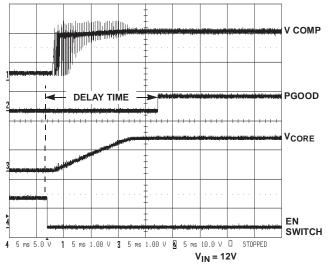
FIGURE 4. START-UP A SYSTEM OPERATING AT 200kHz
