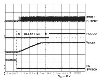
FIGURE 3. START-UP OF A SYSTEM OPERATING AT 200kHz
