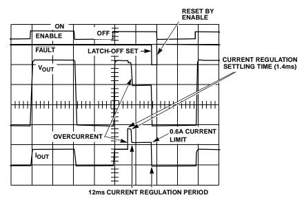
FIGURE 1. OPERATIONAL WAVEFORMS
