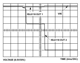
FIGURE 10. SWITCH FAULT INDEPENDENCE
