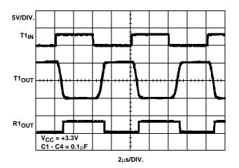
FIGURE 11. LOOPBACK TEST AT 250kbps
