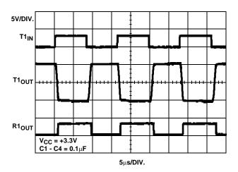
FIGURE 10. LOOPBACK TEST AT 120kbps
