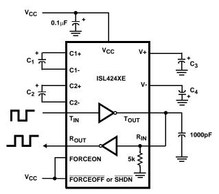
FIGURE 9. TRANSMITTER LOOPBACK TEST CIRCUIT
