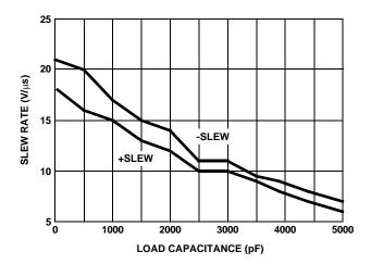
FIGURE 13. SLEW RATE vs LOAD CAPACITANCE
