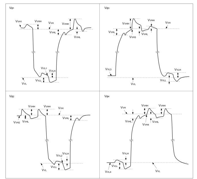
VvH = (VvH1 + VvH2) / 2VvL = (VvL3 + VvL4) / 2 $V\phi = VvHn - VvLn (n = 1 \text{ to } 4)$
