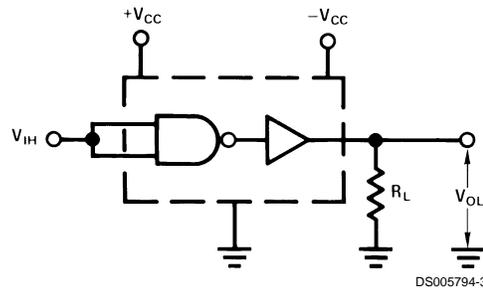
FIGURE 1.  $V_{IH}$ ,  $V_{OL}$
