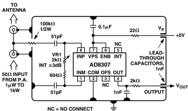
Figure 21. 1  $\mu\text{W}$  to 1 kW 50  $\Omega$  Power Meter
